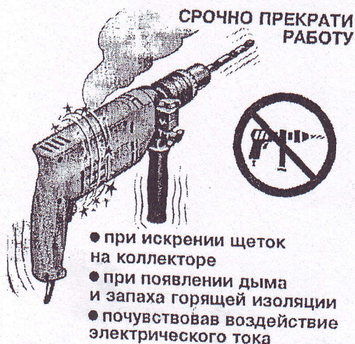
Рис. 11. Неисправности, при которых должна быть прекращена работа ручной электрической машины (плакат)
