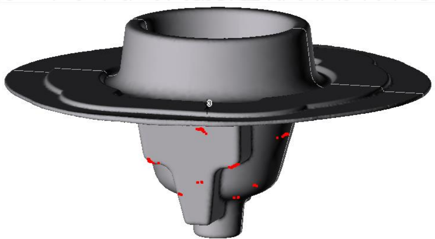
Рис.6. Результат окончательной штамповки при осадке на первой операции до конечного расстояния 165 мм .
