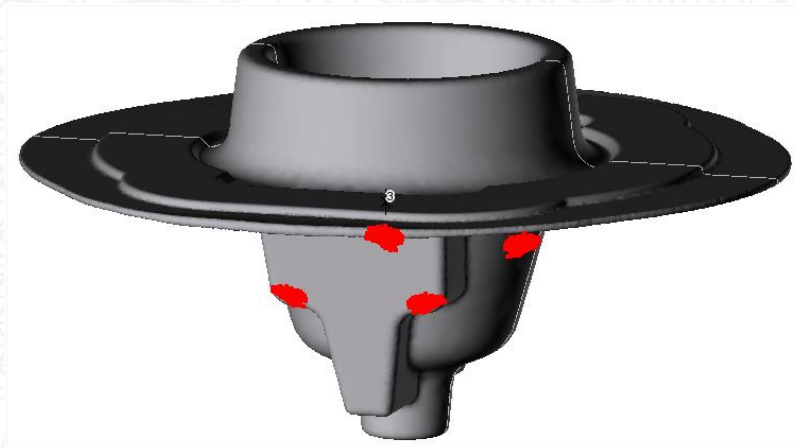
Рис.8. Результат окончательной штамповки при осадке на первой операции до конечного расстояния 155 мм .
