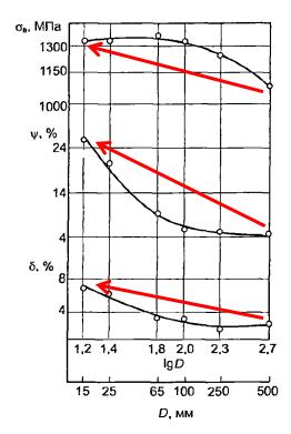
Влияние величины зерна на механические свойства сплава ВТ22И после закалки с 775 °C, I ч, охлаждение на воздухе + старение 525 °C, 4 ч
