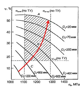
Связь между поперечным сужением и временным сопротивлением разрыву для сплава BT22 с разной величиной зерна
