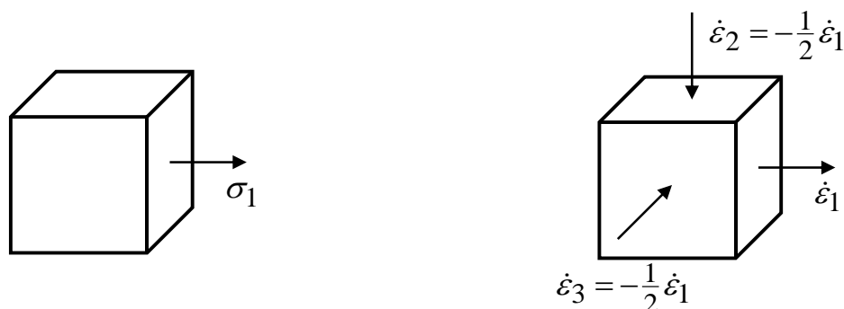
Рисунок 2 – Напряженное и деформированное состояние на рабочей длине образца при испытании на растяжение
